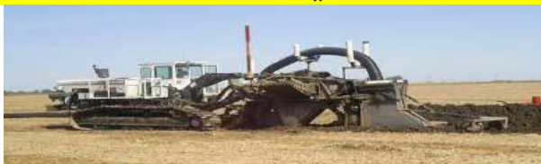
شكل (8-8 أ) : إحدى الآلات المستخدمة في عمل المصارف الحقلية
