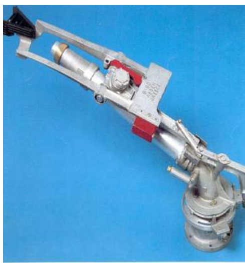
رشاش مدفعى يستخدم فى نظام الرش الثابت المدفعى
