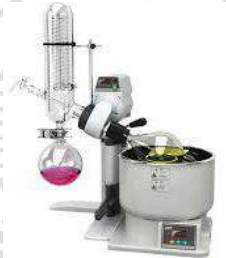
الشكل (32): جهاز المَبْخَر الدَّوَّار Rotary Evaporator المستخدم في تركيز المستخلصات النباتية.
